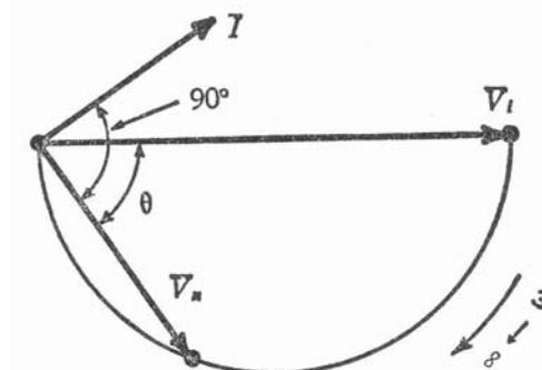
Fig. 2 – Diagramma polare relativo al filtro RC passa basso
