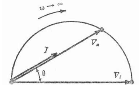
Fig. 7 – Diagramma polare del filtro passa-alto
